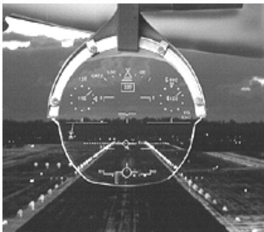
Рис.6.10. Индикация системы HGS на посадке
