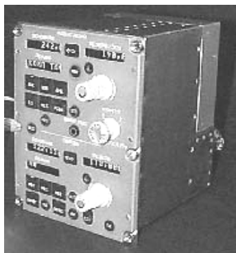
Рис.1.2. Комплексный пульт радиотехнических средств КПРТС-95-1
