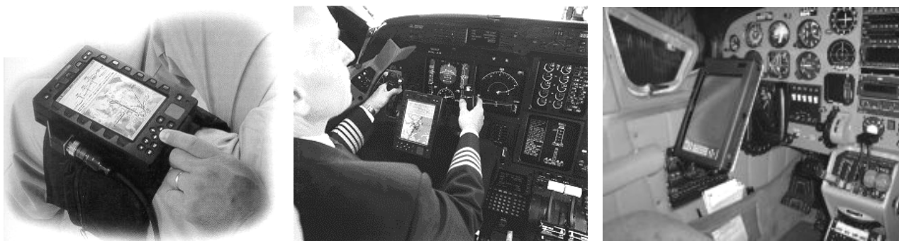
Рис.8.8. Варианты крепления электронных планшетов:
