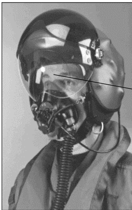
Рис.1.17. Нашлемная система индикации
