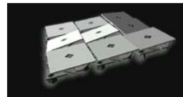
Рис.11.12. Кристалл DMD с зеркалами
