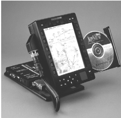
Рис.8.10. Электронный планшет установлен в базовую станцию
