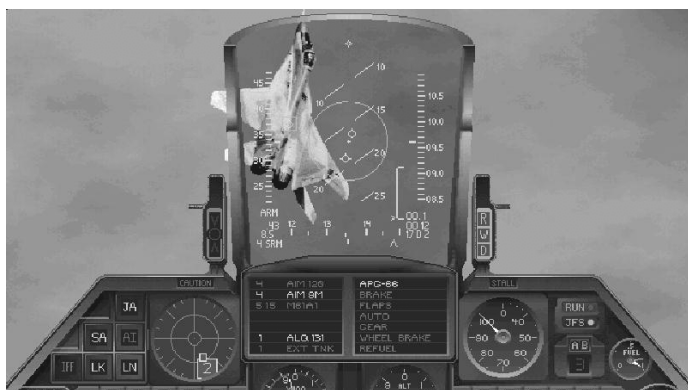
Рис.6.2. Вид индикации на ИЛС военного самолета
