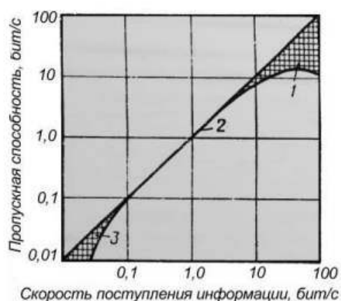
Рис 2.1. Зависимость пропускной способности человека от скорости поступления информации: 1 - перегрузка, 2 - нормальная работа, 3 - затухание активности
