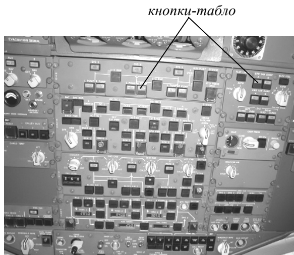
Рис.2.7. Верхняя панель самолета MD-11
