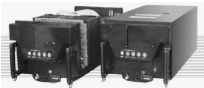
Рис.1.1. Внешний вид блоков инерциальной навигационной системы
