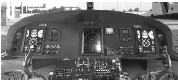
Рис.11.2. Приборная доска вертолета АВ 139 содержит три индикатора с диагональю экрана 12"
