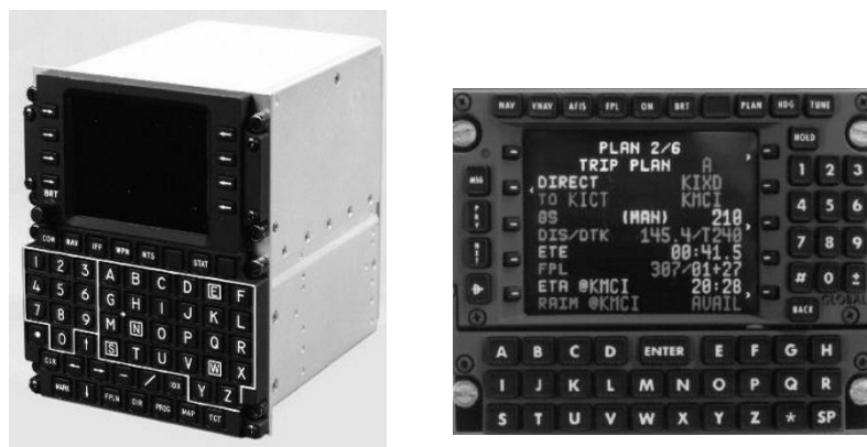
Рис.5.30. Многофункциональные пульты с жидкокристаллическим экраном: CD-200 (слева) и GNS-XLS (справа)
