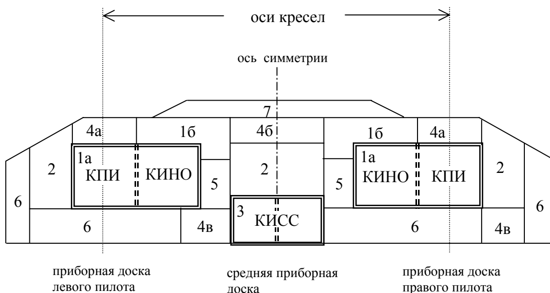
Рис.5.1. Зоны размещения средств индикации на приборных досках
