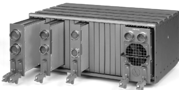
Рис.11.35. Крейт модульной авионики ( Rockwell Collins )
