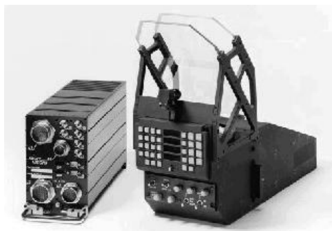
Рис.6.3. Система индикации на лобовом стекле: генератор символов (слева) и индикатор (справа)
