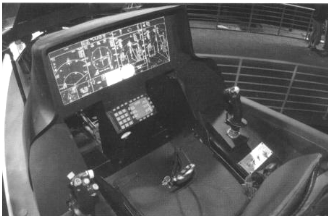
Рис.11.6. Прототип кабины истребителя F-35
