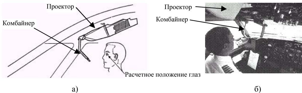
Рис.6.12. Расположение ИЛС в кабине пассажирского самолета: а – схема установки, б – фотография кабины с установленной системой HGS
