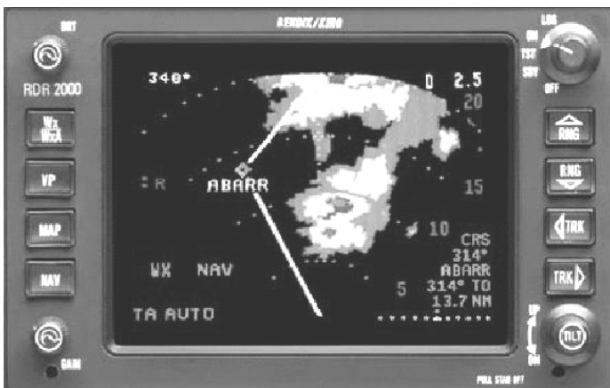
Рис.1.5. Изображение на индикаторе радиолокатора
