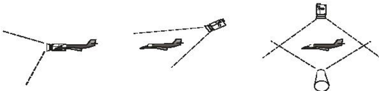
Рис.11.24. Возможные ракурсы изображения траектории полета: слева – «дорога в небе», в центре – экзоцентрический, справа – традиционное изображение в виде 2 проекций
