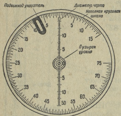
Рис. 19. Внутренняя шкала визира ОПБ-1
