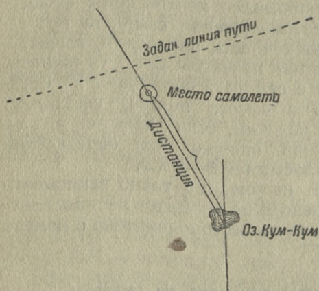
Рис. 67. Определение места самолета по пеленгу и дистанции
