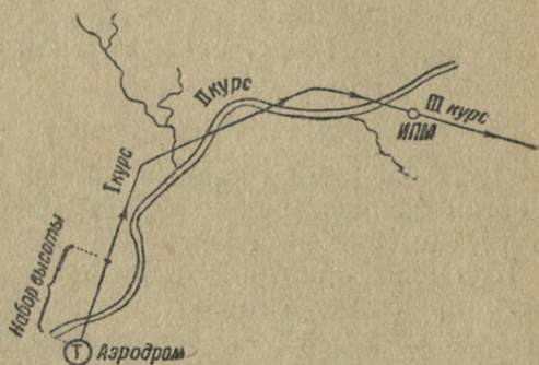
Рис. 55. Выход на курс следования с определением ветра по трем углам сноса
