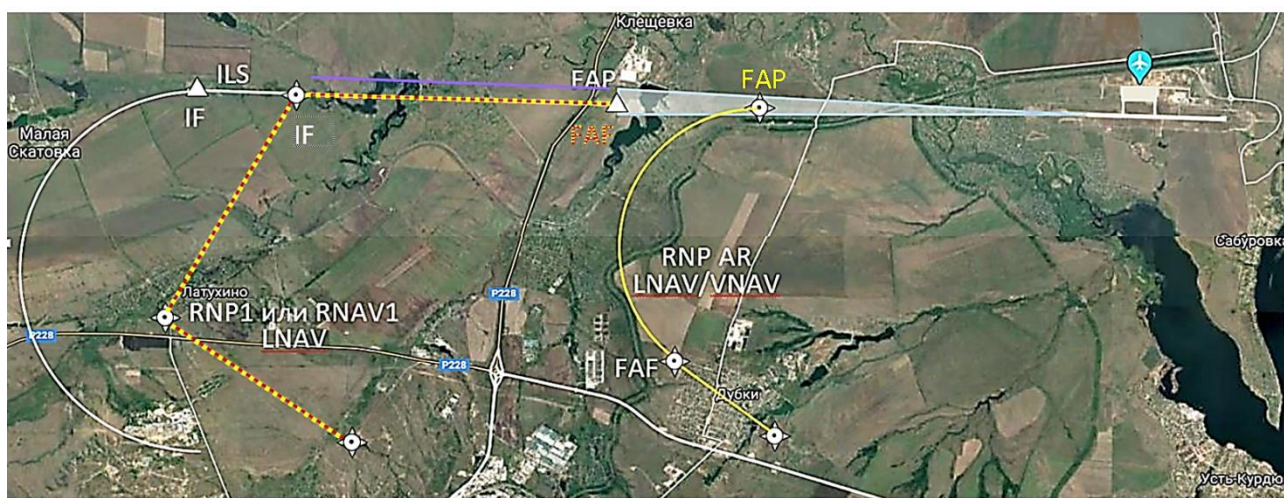
Рис. 4.5. Сравнение траекторий при заходе на посадку по ILS, RNAV 1, RNP AR
