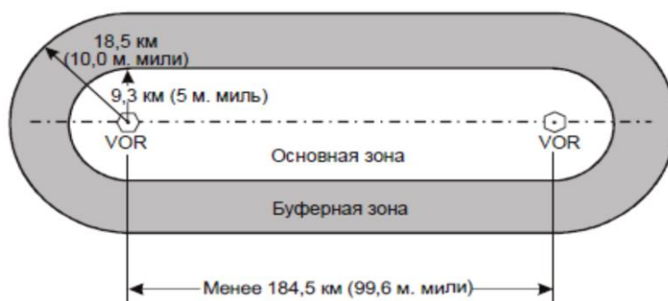
Рис. 6.4. Определение защитного воздушного пространства для участка трассы, основанной на VOR, при расстоянии между маяками менее 184,5 км (99,6 м. мили)
