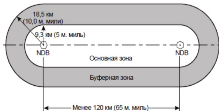
Рис. 6.6. Определение защитного воздушного пространства для участка трассы, основанной на NDB, при расстоянии между маяком и менее 120 км (65 м. миль)
