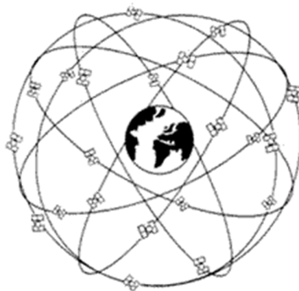
Рис. 5.4. Космический сегмент системы GPS.
