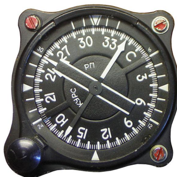
Рис. 9.2. Указатель гиромагнитного радиокompаса (УГР).
