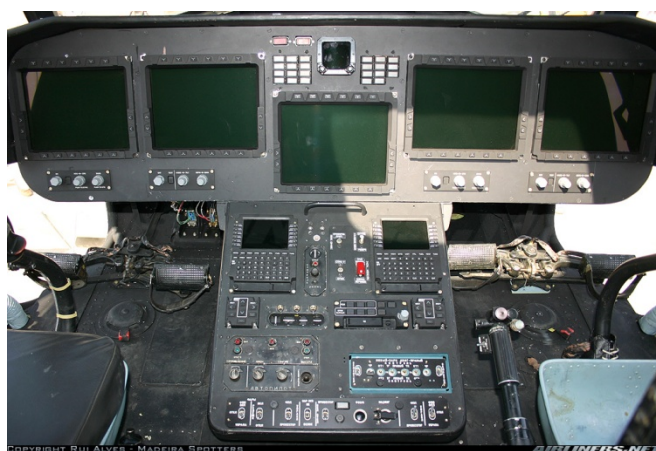
Рис. 1.1. Бортовое пилотажно-навигационное оборудование на базе FMS, установленное на вертолёте Ми-8.
