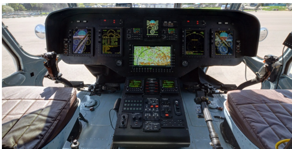
Рис. 9.5. Интегрированное пилотажно-навигационное оборудование вертолёта Ми-8 последних модификаций
