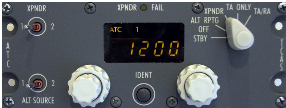
Рис. 8.6. Пульт управления бортовым ответчиком ВОРЛ и системой TCAS самолёта Boeing 737 Next Generation
