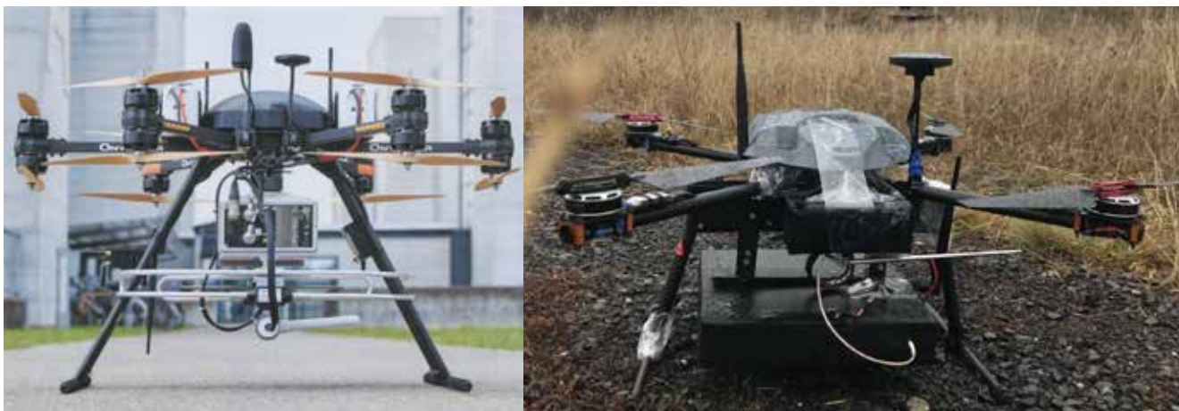
Рисунок 1. Примеры использования БПЛА для проведения проверок технического состояния наземного аэронавигационного оборудования: слева – комплекс на базе БПЛА, эксплуатируемый провайдером аэронавигационных услуг Skyguide (Швейцария); справа – мобильный радиоизмерительный комплекс на базе БПЛА, разработанный компанией «Курсир» (Россия)
