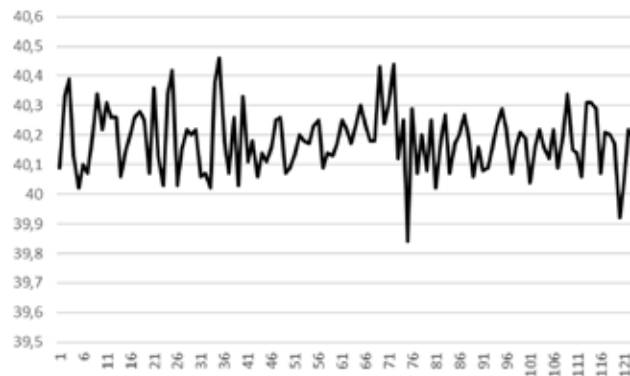
Рисунок 6. Значения параметра суммы глубины модуляции (СГМ) сигналов 90 Гц и 150 Гц в процентах
