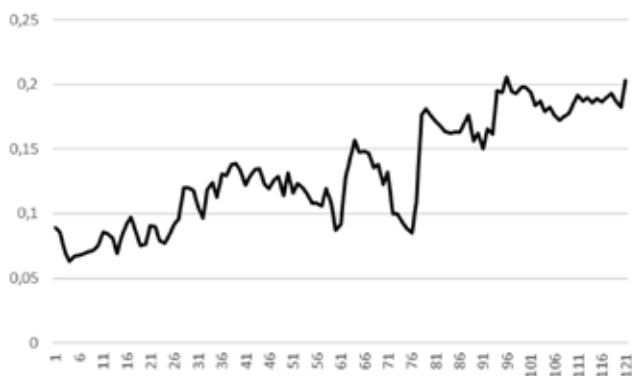
Рисунок 5. Значения параметра разности глубины модуляции (РГМ) сигналов 90 Гц и 150 Гц в относительных величинах
