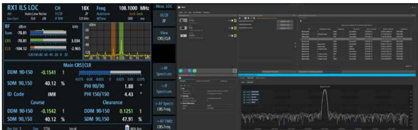
Рисунок 4. Результаты оценки технических параметров оборудования системы инструментальной посадки: слева – на экране специального средства измерения (анализатор аэронавигационных сигналов); справа – на рабочем месте оператора
