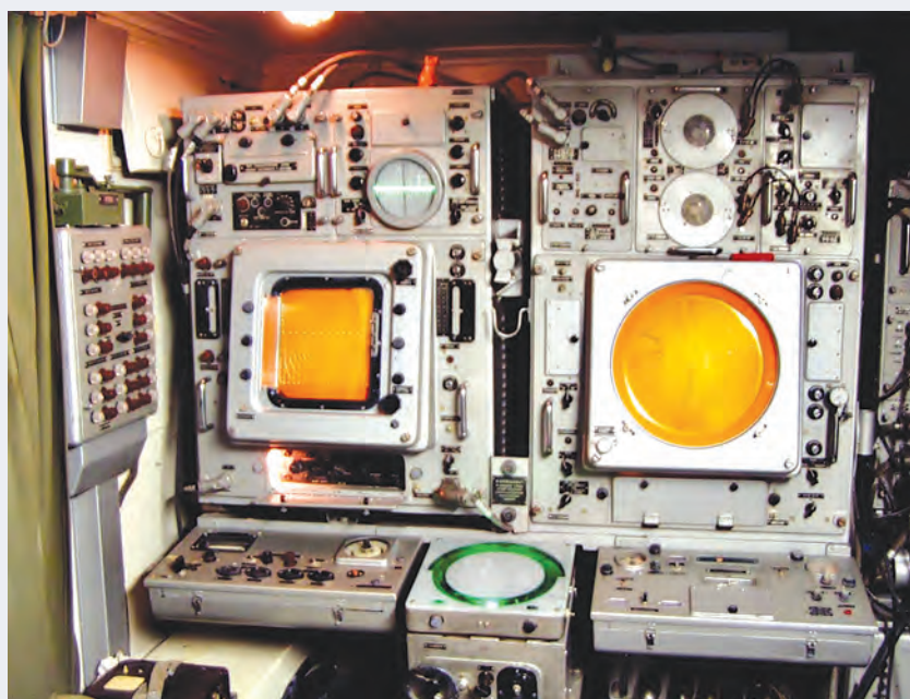
РЛС П-12 «Енисей» (индикаторная аппаратура в аппаратной машине)
