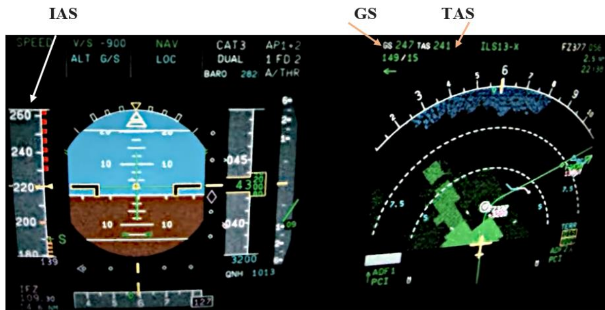
Рисунок 14. Пример отображения скоростей на индикаторах ВС
