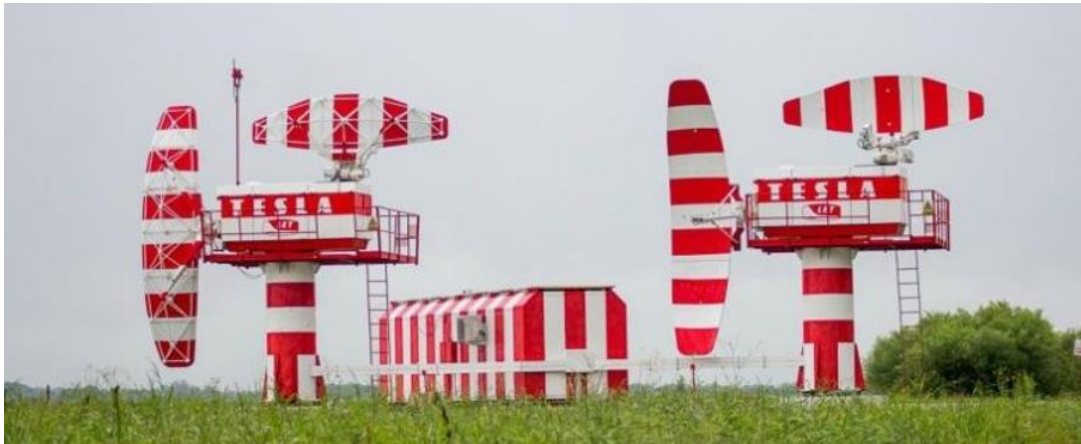
Рисунок 10. Антенные системы посадочного радиолокатора
