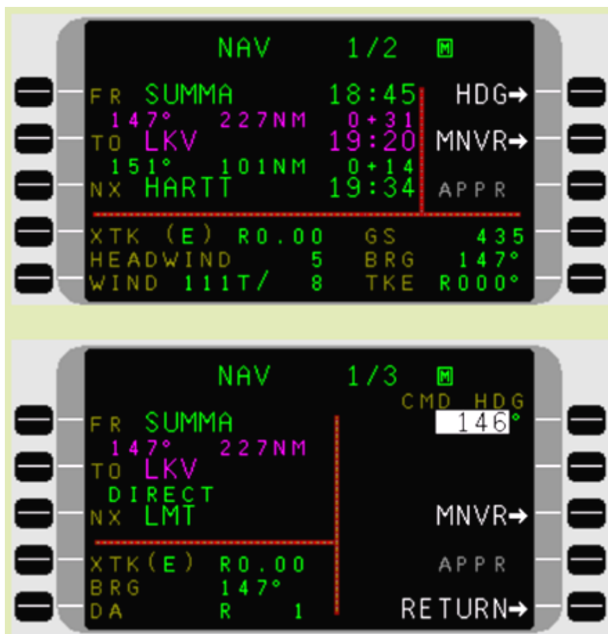
Рис. 10.23. Две навигационные страницы, индицируемые на пульте управления FMS
