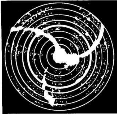
Рис. 6.18. Вид помехи от импульсной РЛС на экране индикатора
