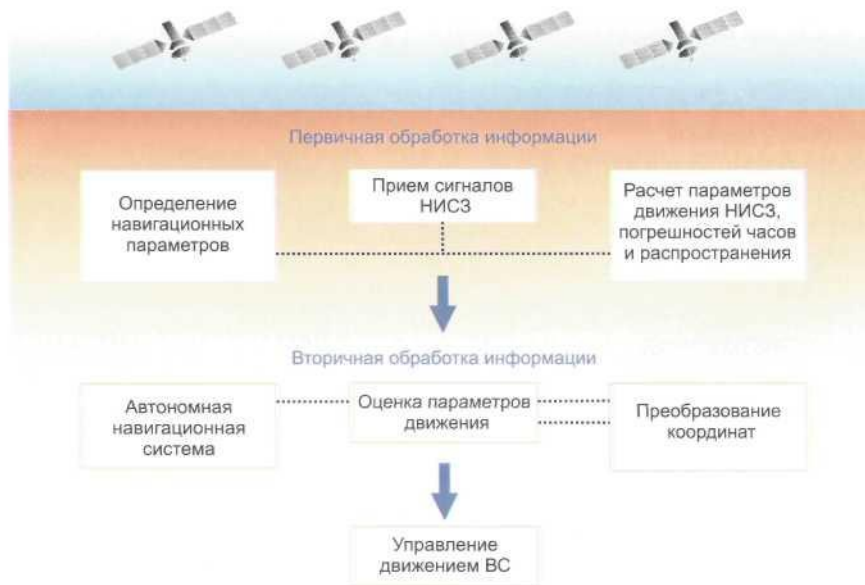
Рис. 2.2. Схема прохождения и обработки информации в бортовой аппаратуре CPNC
