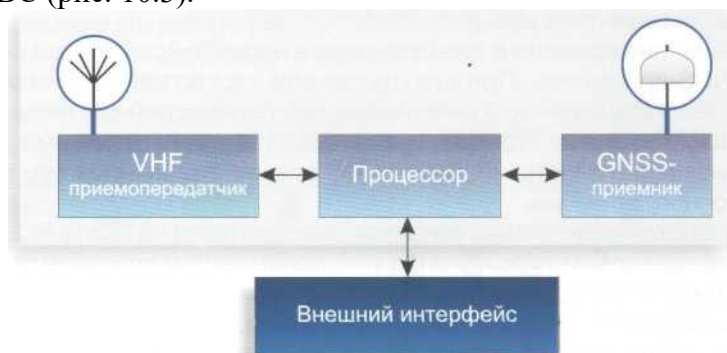
Рис. 10.2. Структурная схема транспондера АЗН-В Спутники GNSS
