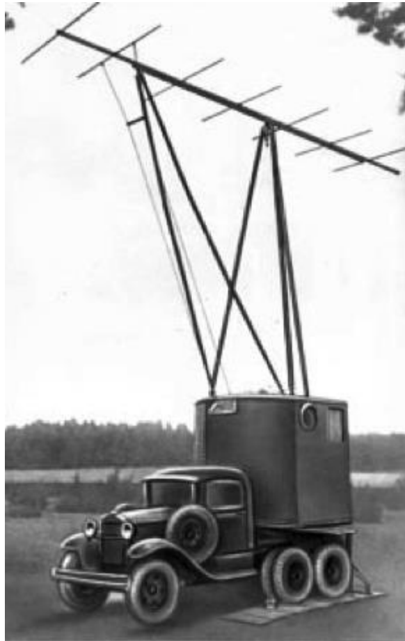
Двухантенный вариант РЛС РУС-2. Приёмная установка с вращающейся вместе с антенной кабиной оператора
