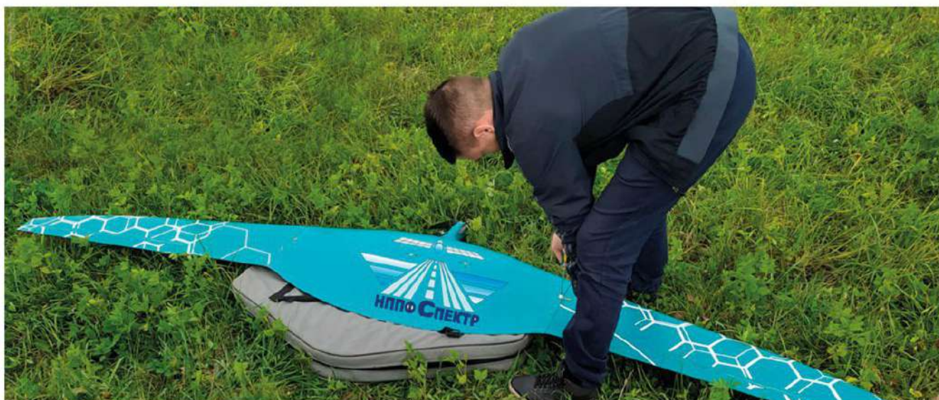
Летные проверки ЛККС-А-2000 на аэродроме Горно-Алтайск с использованием БАС
